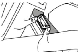
Senza premere il pulsante e con motore al minimo, il dispositivo si accenderà automaticamente dopo circa 8 secondi. Il simbolo della clessidra a lato del display inizierà a lampeggiare, segnalando che il dispositivo sta registrando. **ATTENZIONE:** nel caso lampeggiassero tutte le cifre, il dispositivo sta segnalando una anomalia: in tal caso si prega di contattare il proprio rivenditore.
