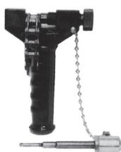
Legen Sie die Kette in die Haltevorrichtung und fixieren Sie sie mit der Halteschraube.
