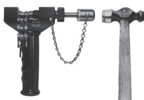
Führen Sie den Trennbolzen ein und schlagen Sie mit einem Hammer kräftig auf den Bolzen. Kontrollieren Sie zwischendurch ob die Halteschraube noch fest sitzt.
