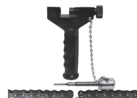
Schlagen Sie solange auf den Trennbolzen bis der Kettenbolzen herausfällt. Lockern Sie nun die Halteschraube und ziehen Sie den Bolzen heraus.
