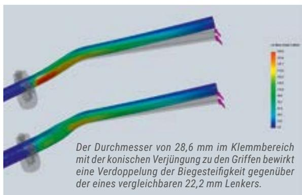
Der Durchmesser von 28,6 mm im Klemmbereich mit der konischen Verjüngung zu den Griffen bewirkt eine Verdoppelung der Biegesteifigkeit gegenüber der eines vergleichbaren 22,2 mm Lenkers.
