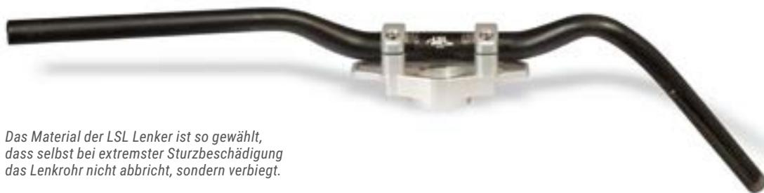
Das Material der LSL Lenker ist so gewählt, dass selbst bei extremster Sturzbeschädigung das Lenkrohr nicht abbricht, sondern verbiegt.
